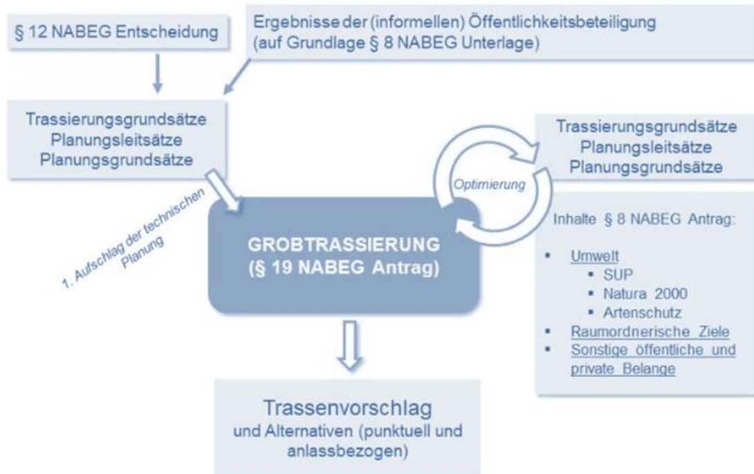
Abbildung 3: Der iterative Prozess der Grobtrassierung für die Entwicklung des Trassenvorschlags und der in Frage kommenden Alternativen für den Antrag gemäß § 19 NABEG
