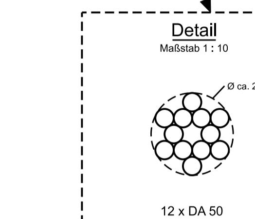
Biegeradius für LWL-Schutzhülsen mind. 100 x DA (bei DA 50 => 5m). In Ausnahmefällen 50 x DA (> 2,5m). Der mind. Radius für die LWL ist 20 x D unter Zugkraft bzw. 15 x D ohne Kraft. LWL werden nur auf der LWL-ZS ohne Schutzhüse verlegt. (Telekom-LWL 19 cm Außen Durchmesser, Monitoring-LWL 9,3 cm Außen Durchmesser)
