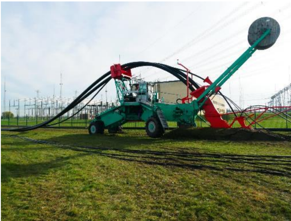
Abbildung 8: Mehrfachpflug mit dem Doppelverlegeschacht mit dem System von Walter Föckersperger GmbH
