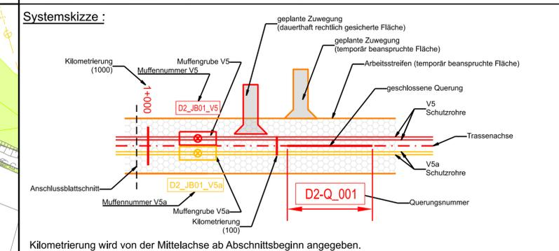
Kilometrierung wird von der Mittelachse ab Abschnittsbeginn angegeben.
