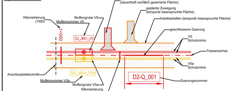
Kilometrierung wird von der Mittelachse ab Abschnittsbeginn angegeben.
