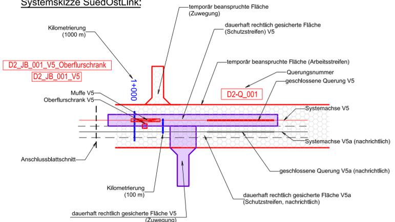
Kilometrierung wird von der Systemachse ab Abschnittsbeginn angegeben.
