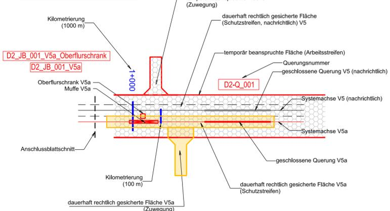
Kilometrierung wird von der Systemachse ab Abschnittsbeginn angegeben.
