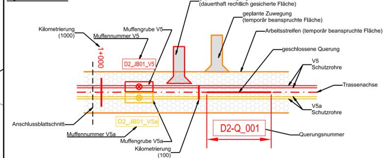
Kilometrierung wird von der Mittelachse ab Abschnittsbeginn angegeben.
