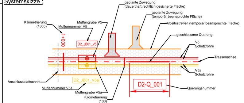
Kilometrierung wird von der Mittelachse ab Abschnittsbeginn angegeben.
