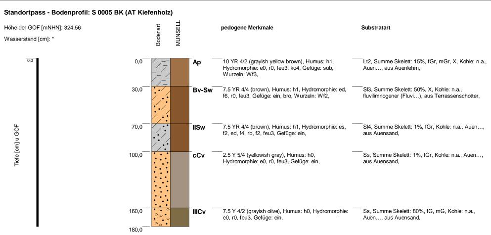
Bemerkung: Gründüngung 100-160 Ccv --> Carbonatsand 160-180 Cv --> Kies \*Werte [0,0] und [-99] = kein Wasser angetroffen oder nicht erkennbar, da Aufnahme im Kernlager
