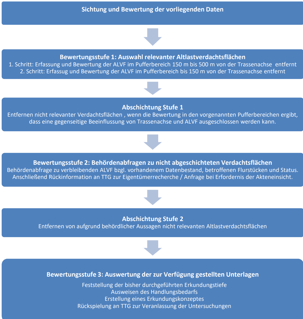
Abbildung 1: Prozess zur Bewertung und Abschichtung von Altlastverdachtsflächen
