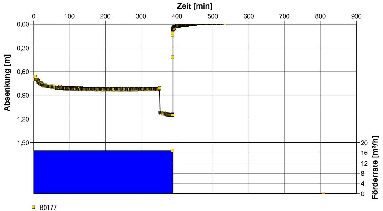
Gemäß Dateninterpretation, wurden zwei Pumpstufen gefahren. In den Daten zum Pumpversuch ist jedoch nur eine Förderrate angegeben. Dies erscheint unplausibel.
