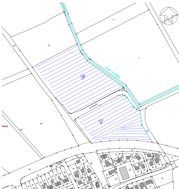
Abbildung 2: Einzelausmündersystem (Prinzipskizze) Darstellung der Sauger in Dunkelblau, der Vorflut in Hellblau.
